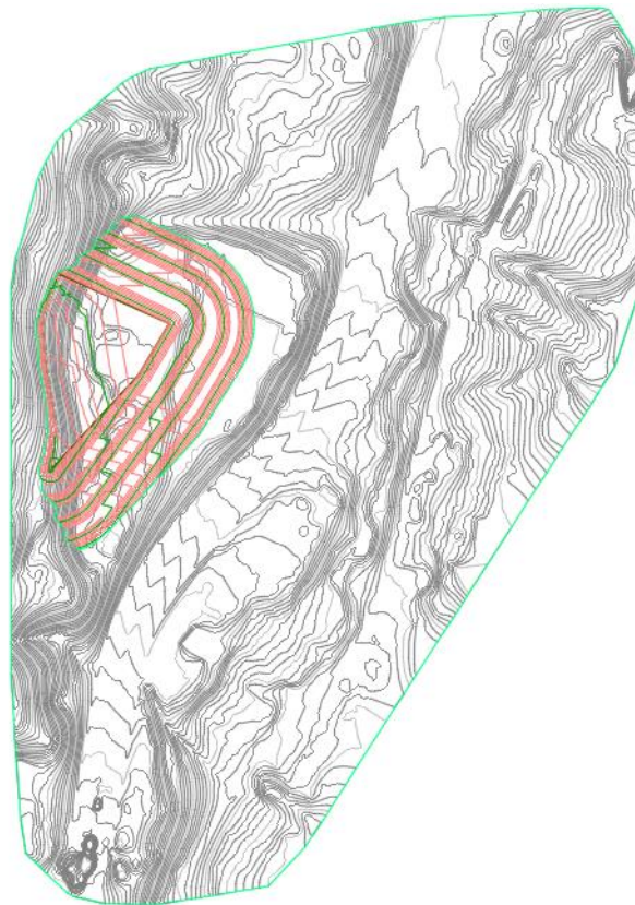
Ilustración 9 Implantación de escombrera
