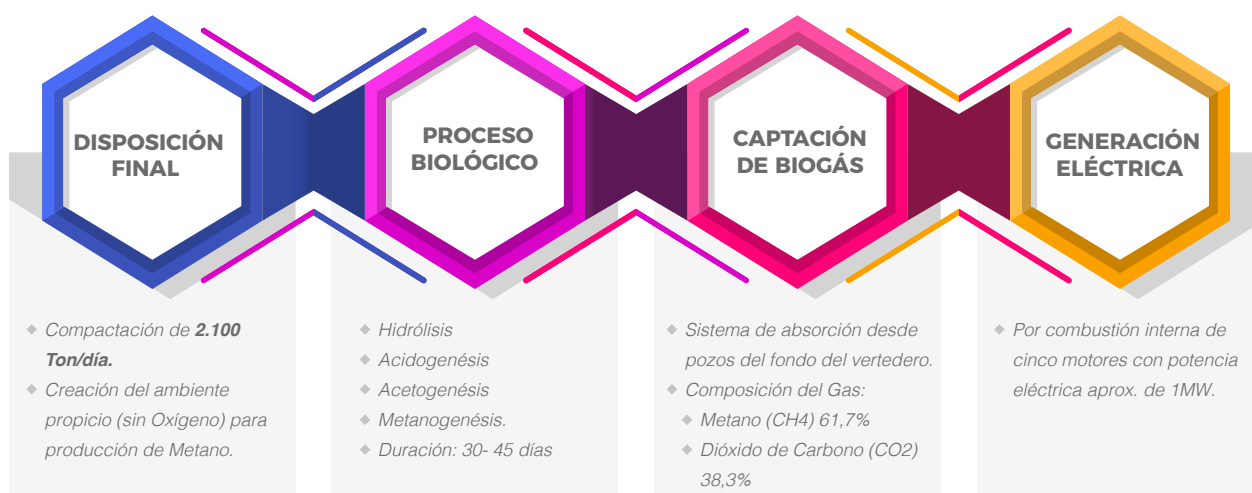
Diagrama 3: Descripción del proceso de generación de biogás.
